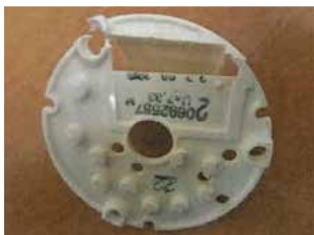
Untere Lagerplatte des Zählwerkes. Die Beschädigungen sind gut zu erkennen.
